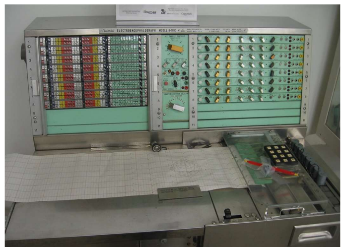
Figure 1 : Illustration d'un des premiers électroencéphalographes (Grass, modèle 8-10C).
